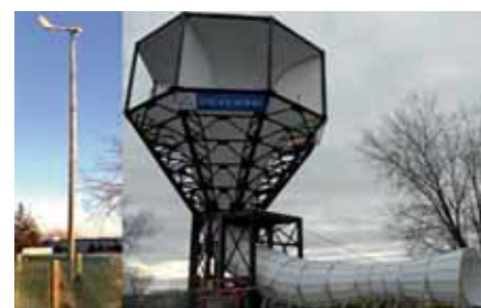
Obrázok č. 2: Pokusná turbína INVELOX pri meraní parametrov
