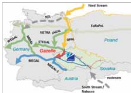
Sítě středoevropských plynovodů
