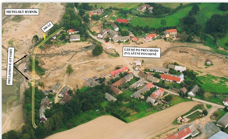
Obr. 1 Obec Metly pod porušeným vodním dílem Metelský rybník (2002) [17] - na obrázku jsou patrné dva průlomové otvory a část obce zničená zvláštní povodní.
