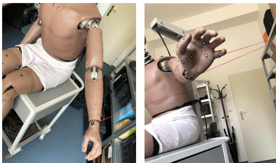
Obrázok 2 Príprava časti tela figuríny na skenovanie a rozmiestnenie referenčných bodov - príklad
