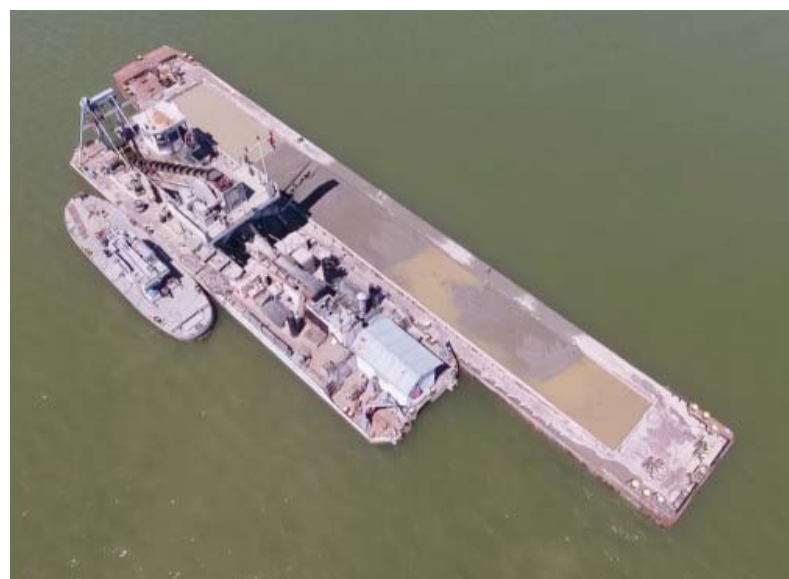
Obr. 7 BD Vtáčnik vykladajúci sedimenty do nákladného člna, 2017 [1]
