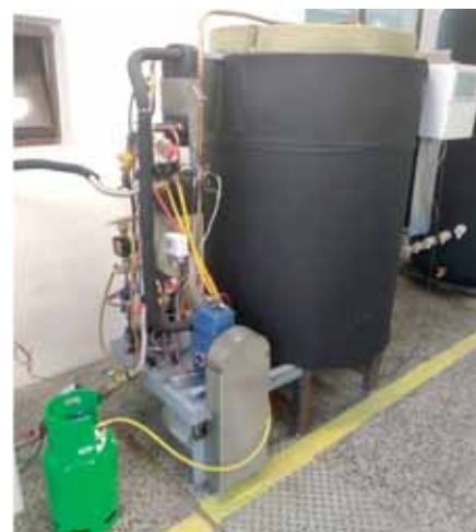
Obrázek č. 4: Experimentální „stand“ pro měření vysokoteplotního tepelného čerpadla a akumulátoru s kamenným prachem
