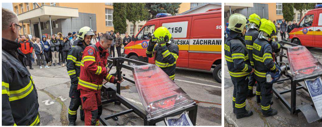
Obrázok 6 Strihanie A stĺpika, s dvoma typmi zariadení s rozdielnym pohonom
