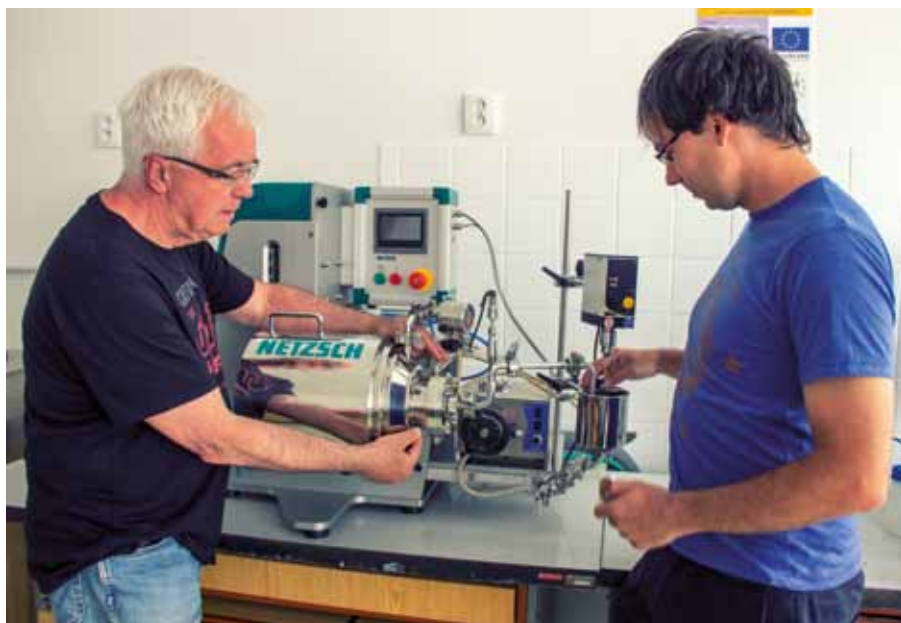
MECHANOCHEMICI PETER (VĽAVO) A MATEJ BALÁŽOVCI ZAPŮZOVALI PRI FARMACEUTICKOM MLYNE MINICER, KTORÝ SLUŽI NA PRÍPRAVU NANOSUSPENZIÍ.
