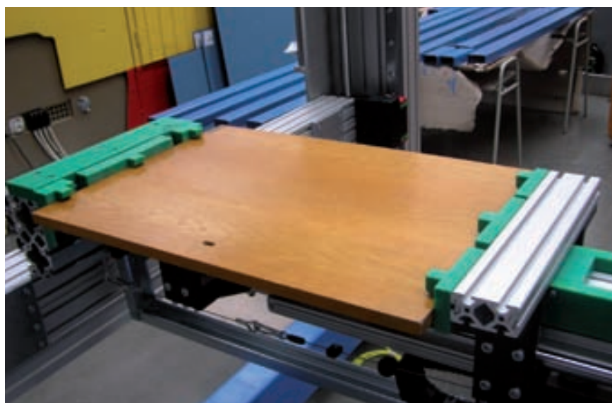
Obr. 2a,2b Systém manipulácie a uchopenia s dreveným dielcom
