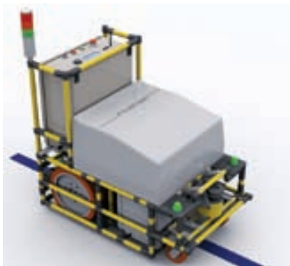
Obr. 2: CEIT FTS-2000 (AGV zariadenie s ťažnosťou 2t)
