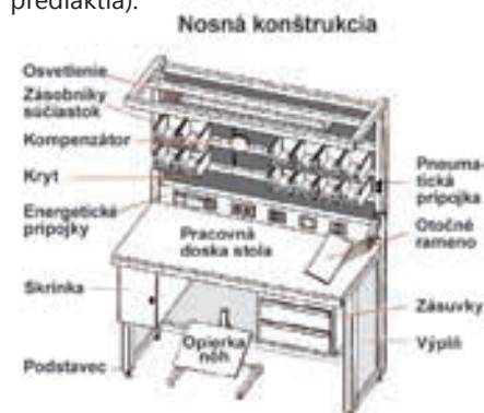
Obr. 1 Zariadenie pracoviska ručnej montáže
