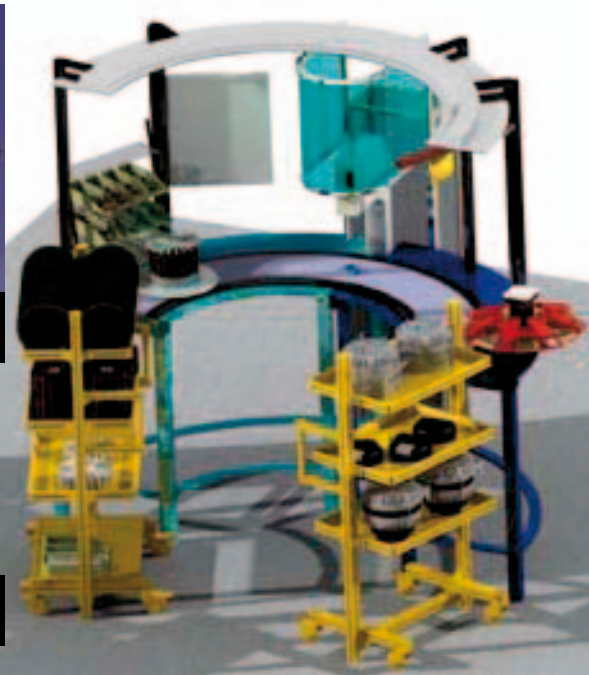
Obr. 3 One piece flow ručné montážne pracovisko pre montáž alternátora
