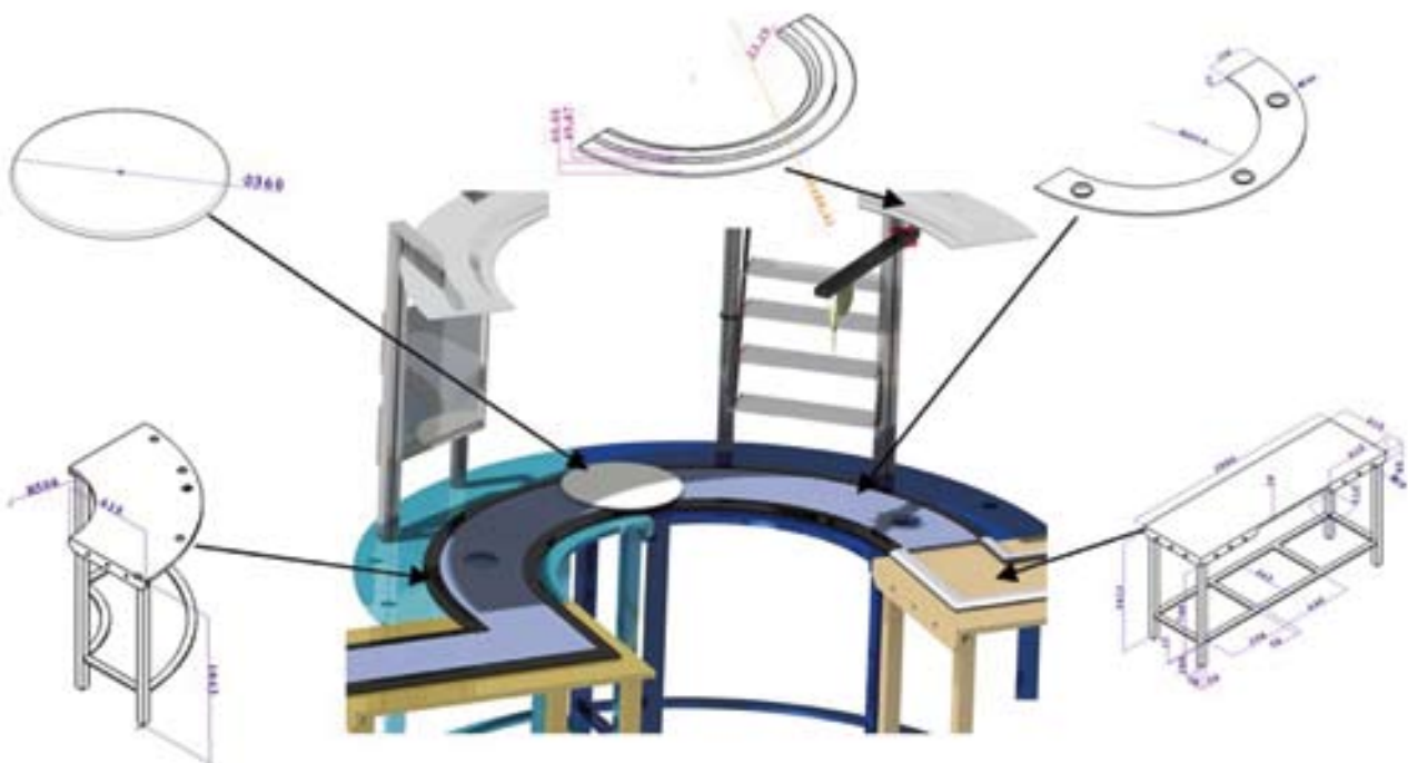
Obr. 2 Vybrané komponenty one piece flow pracoviska ručnej montáže
