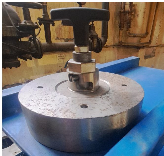
Obr. 4 Upínací prípravok z hornej strany
