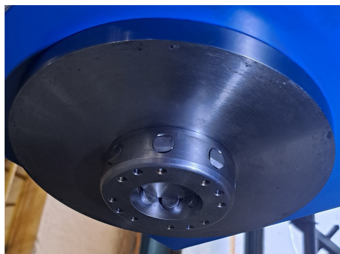
Obr. 5 Upínací prípravok zo spodnej strany
