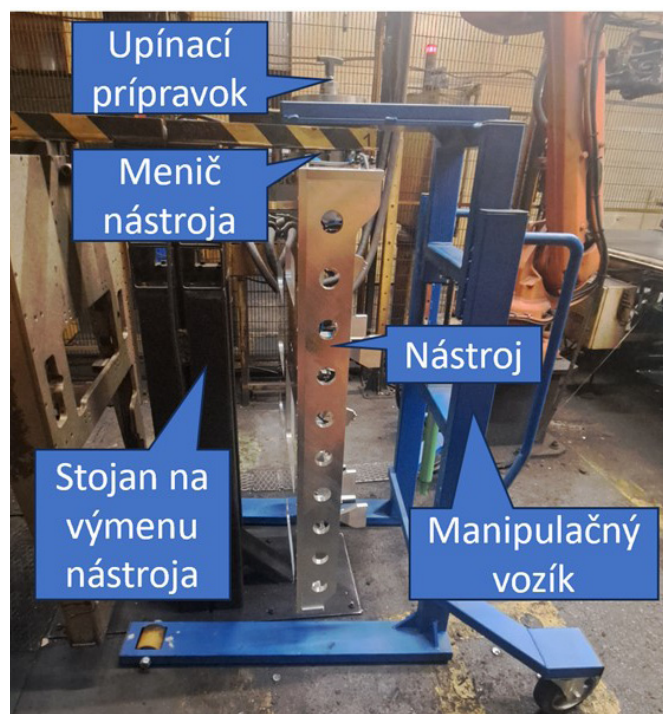
Obr. 2 Upínací prípravok ako súčasť manipulačného vozíka
