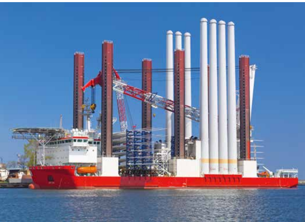
Plavidla, s jejichž pomocí jsou na moře umísťovány větrné turbíny, v Polsku kotví například v gdaňském přístavu. Největší takové stroje zvládnou instalovat základy o váze až 3000 tun v hloubce 70 metrů a větrníky s nosnou věží vysokou 300 metrů
