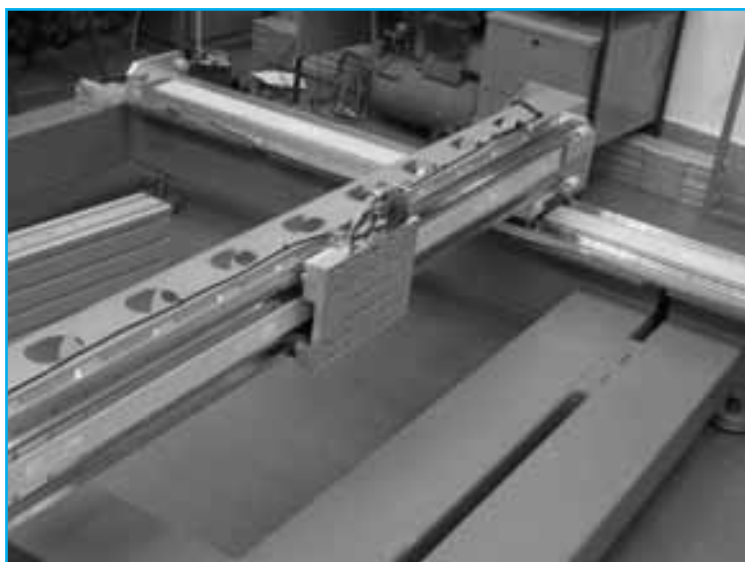
Obr. 7 Polohovací systém - lineárne motory
