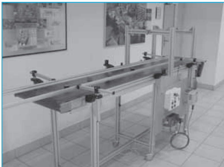
Obr. 1 Stanica vizuálnej kontroly
