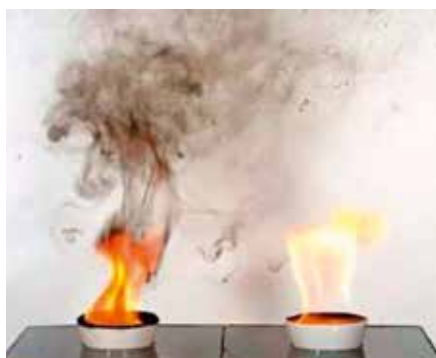
Obrázok č. 3: Definované palivá pri horení nedymia. Pokus ukazuje, ako horí palivo nedefinované v porovnaní s palivom definovaným.
