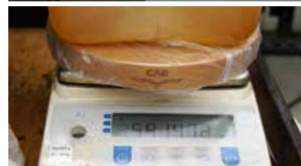
Obrázek č. 5: Měření spotřeby paliva na traktoru ve zkušebně České zemědělské univerzity; hmotnost paliva se vážila každou vteřinu na přesné váze a z každého časově ohraničeného úseku měření se vypočítal průměr.
