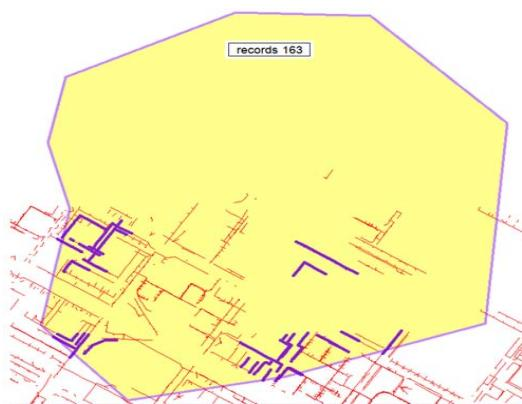
**Слика 7б:** Резултат просторног упита добијен пресеком два лејера: **цеви и геотермалне зоне**
