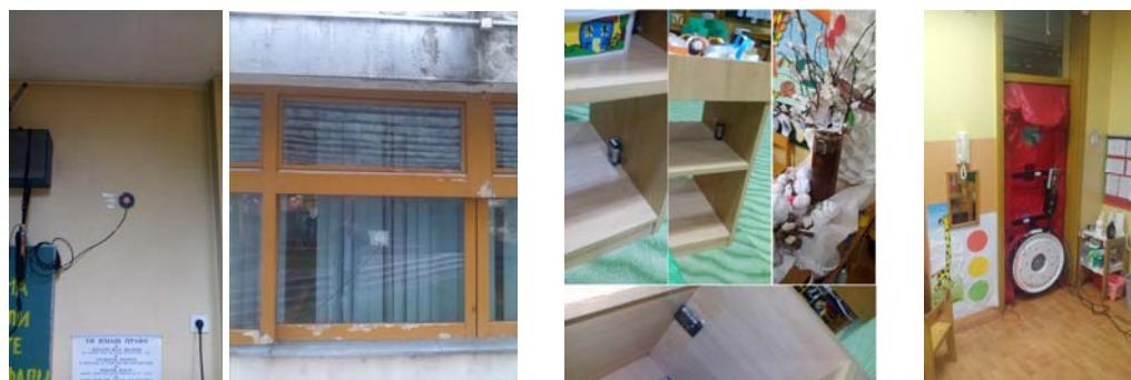
Slika 6: Prikaz mjeranja - prolaza toplote kroz zid i staklo prozora, lijevo, unutrašnje temperature, u sredini i vazduhopropusnosti, slika desno u periodu decembar 2015 – januar 2016.
