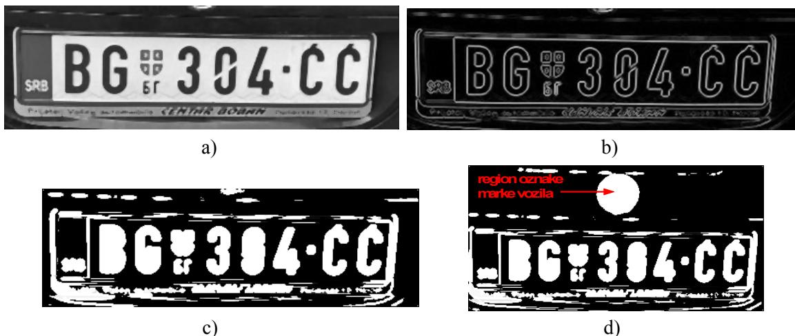
**Slika 3:** a) Uklanjanje šuma Median filtrom b) Izdvajanje ivica Sobelovim detektorom c) Rezultat primene operacije erozije i dilatacije d) Eliminacija oblasti regiona oznake marke vozila
