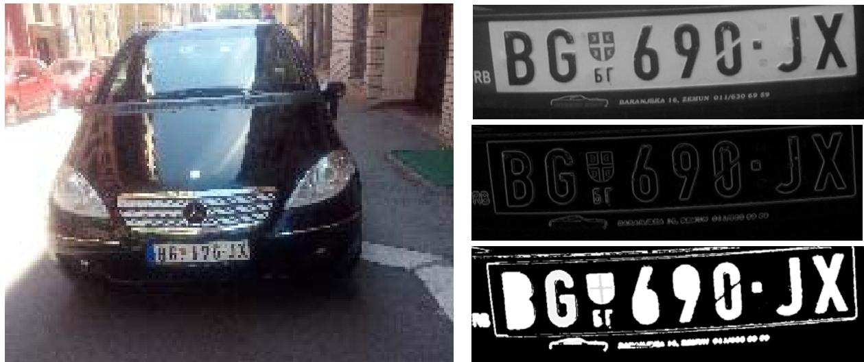
**Slika 9:** Detekcija u slučaju vozila u pokretu (prilikom parkiranja), uz primenu Motion Blur filtra
