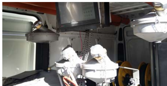
Obr. 1 Odmerné nádoby a priemyselný počítač so špecializovaným SW v meracom vozidle pre kalibráciu a overovanie výdajných stojanov PHM
