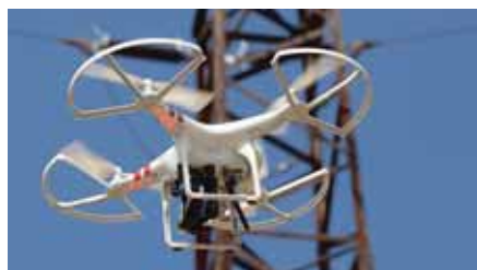
Obrázek č. 3: Další testovaný dron – kvadrokotéra DJI Phantom 2, určen pro minikameru GoPro Hero
