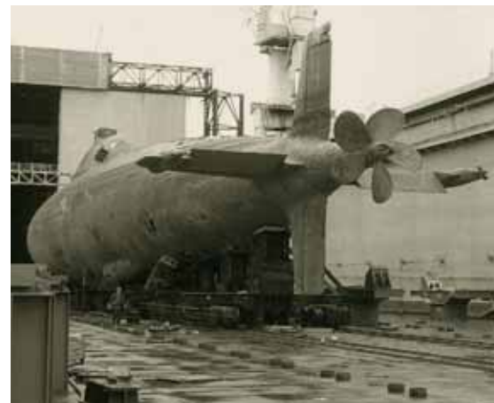
Jedna z ponorek třídy Lira – svého času nejrychlejší ponorka světa – používající jako zdroj energie rychlý reaktor chlazený olovem a bismutem
