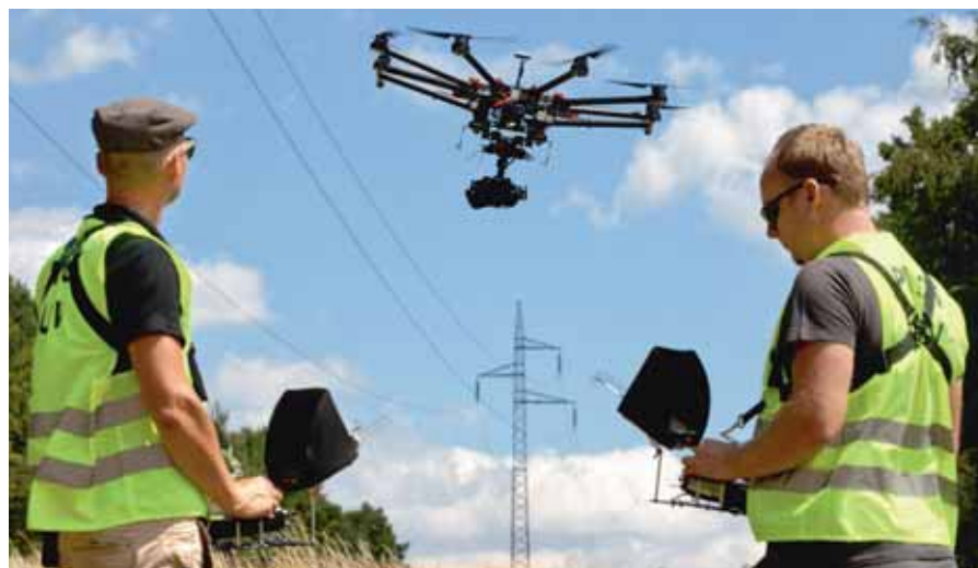
Obrázek č. 1: Jeden z testovaných dronů – oktokoptéra DJI S1000, nosnost až 5 kg, záběr pro Panasonic GH4
