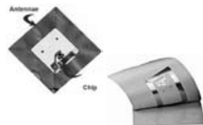
Obr. 3 Pasívny RFID štítkov
