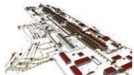
Obr. č. 4 Komplexný 3D priestorový model zhotovený 3D laserovým skenovaním
