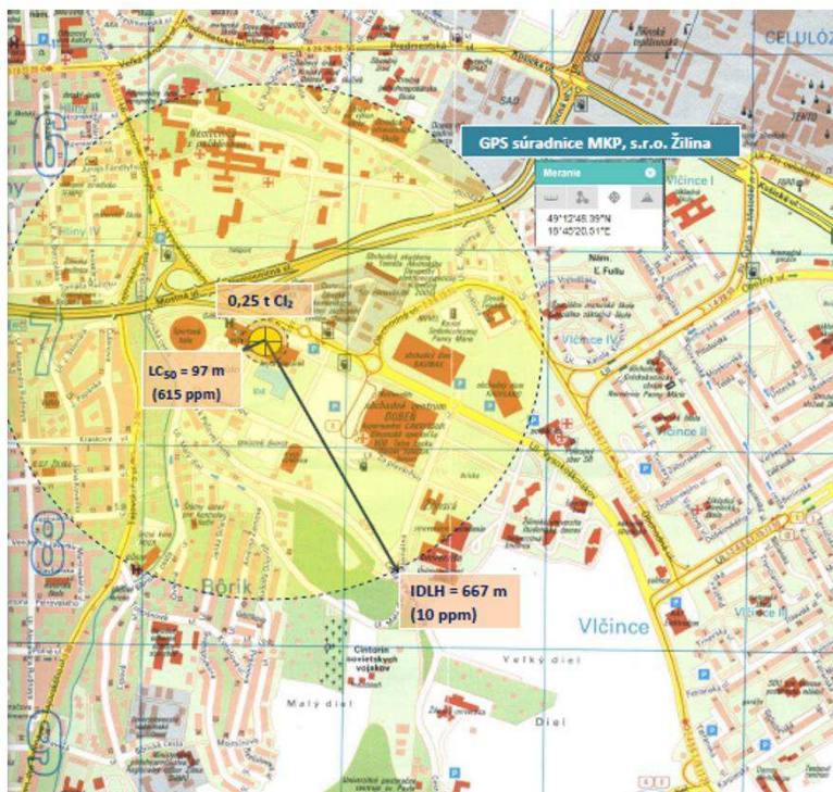
Obrázok 2 Pásмо ohrozenia v prípade úniku chlóru ( \text{Cl}_2 ) v objekte MKP Žilina [1]
