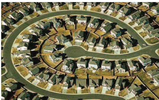
Obr. 2 Příklad suburbánní developerské výstavby nerespektující základní bezpečnostní pravidla dostupnosti a prostupnosti území
