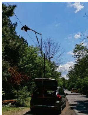
Slika 3: Nosač kamere sa stabilizatorom postavljen na automobil
