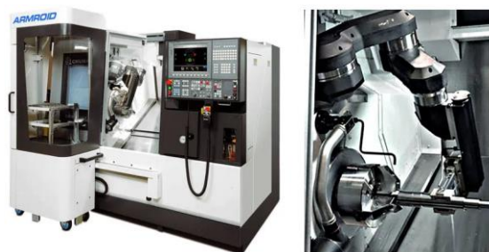
Obr. 4 CNC sústruh s integrovaným robotom [7]
