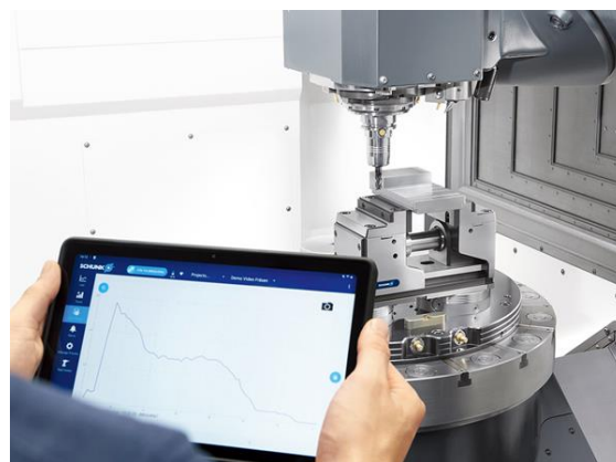
Obr. 5 Upínač frézovacích nástrojov vybavený snímačom a tablet s aplikáciou pre sledovanie zaťaženia nástroja [8]
