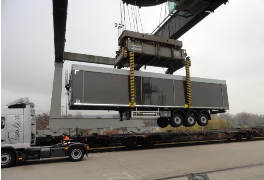
Obrázok 4 Preprava cestných návesov (tzv. huckepack alebo piggyback)
