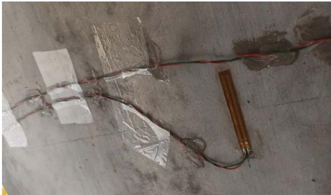
Obrázek 7: Fotografie detailu přilepení odporového tenzometru [10]
