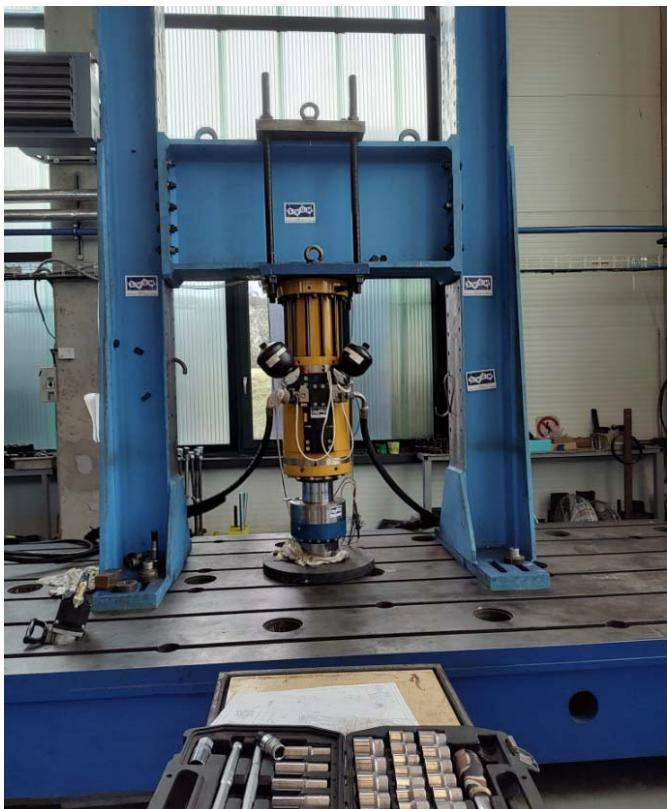
Obrázek 8: Lis pro vyvzování únavového zatížení předpjatého panelu
