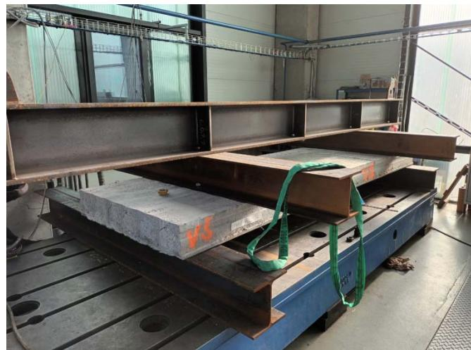
Obrázek 6: Fotografie zkoušeného panelu SPIROLL na únavu [10]
