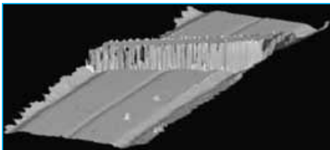
Obr. 2 Skenovaný úsek diaľnice s premostením
