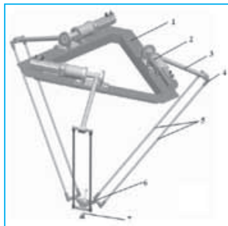
Obr. 5 Model Delta robota (KAVS): 1 – horná platforma, 2 – pohonový subsystém, 3 – hnacie rameno, 4 – guľový kĺb, 5 – hnacie rameno, 6 – pohyblivá platforma, 7 – vákuový efektor
