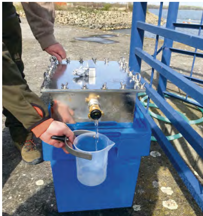
Sedimentačný box na odber suspedovaných častíc a mikroplastov
