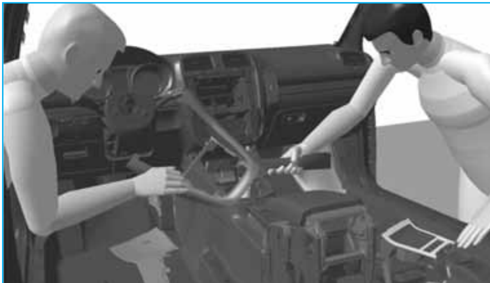
Obr. 2 Montáž konzoly v Delmii V5 DPM Assembly
