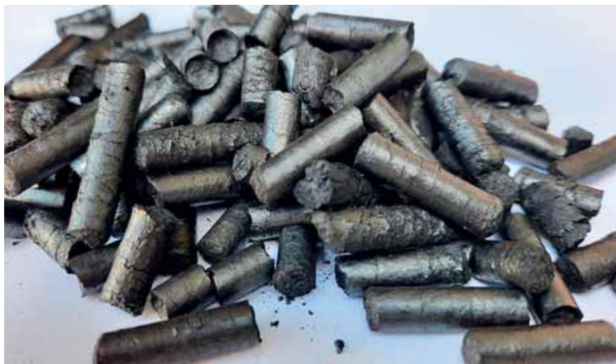
Obrázek č. 1: Biouhel vyrobený z ČK je pevný uhlíkatý produkt získaný mikrovlnnou torrefakcí čistírenského kalu technologií EMT01, má v případě čistého materiálu kalorickou hodnotu v poměrně širokém rozmezí 9-13 MJ/kg a závisí na původním množství organického uhlíku obsaženého v sušeném kalu. Z výsledků projektu dále vyplývá výrazný vliv případných aditiv.
