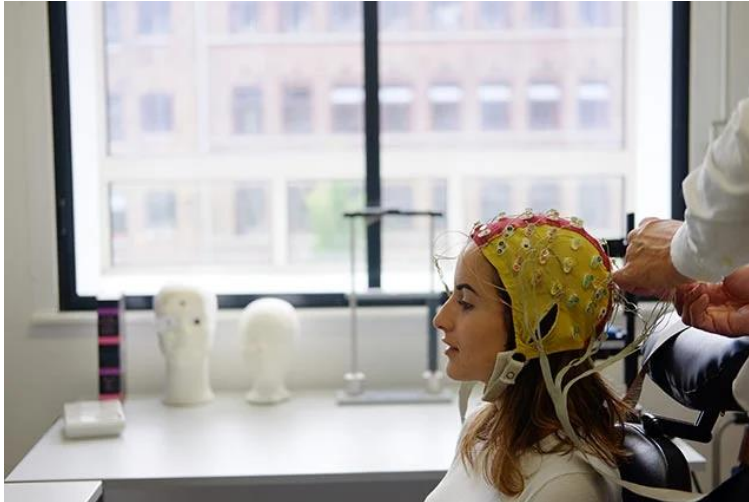
Obrázok 1 Senzory EEG zabudované v čiapke
