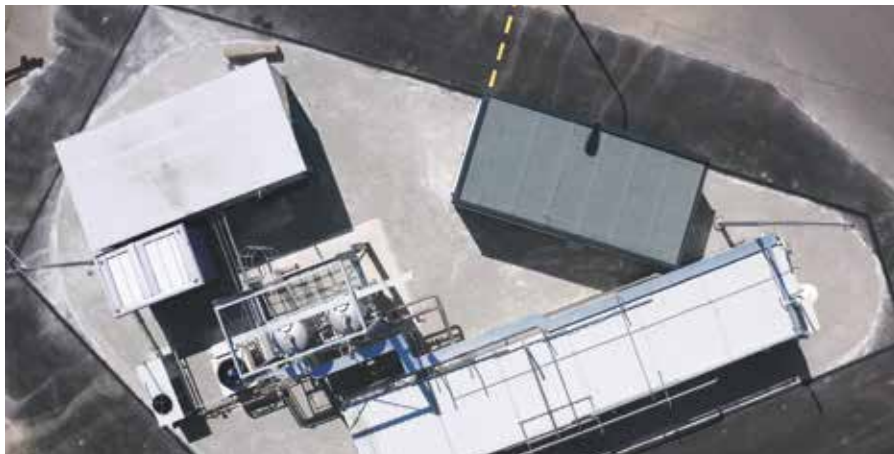
Pohled shora na výrobu biometanu na ÚČOV
