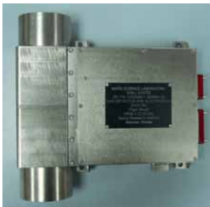
Neutronový generátor pro vozítko Curiosity Zdroj: IKI RAN
