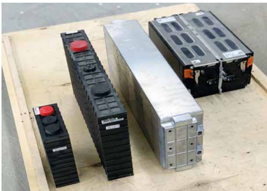
Zleva 2 x LiFePO4 články a 2 x Li-Ion moduly připravené pro Second life aplikace
