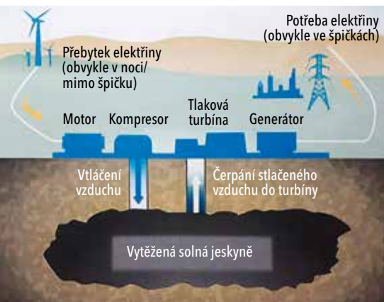
Ukládání energie pomocí stlačeného vzduchu do solné jeskyně
