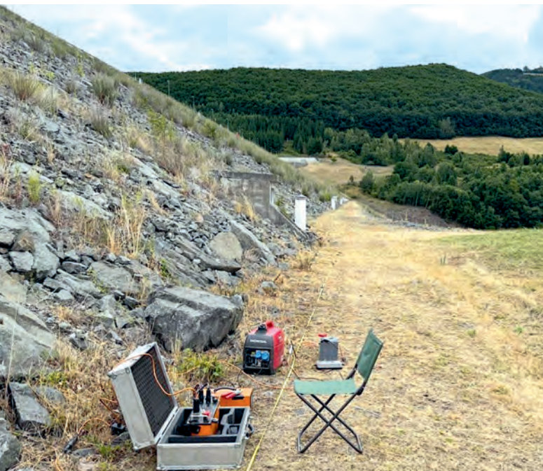
Realizácia povrchových geofyzikálnych meraní na telese priehrady VN Málinec (júl 2025)
