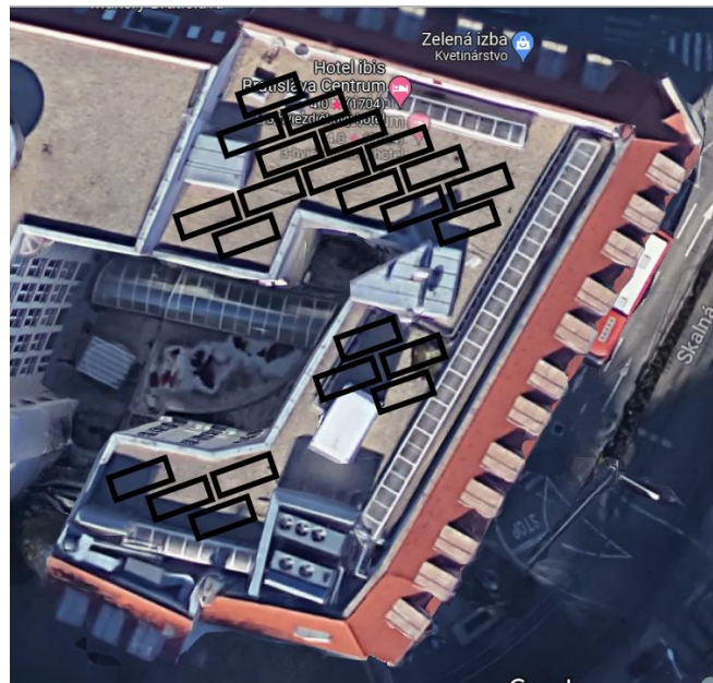
Obrázok č. 7 Umiestnenie fotovoltaických panelov na streche hotela Ibis
