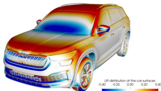
Obr. 7 Rozloženie zdvihovej sily – tlaku vo zvislom smere po skúmanej karosérii vozidla [9]
