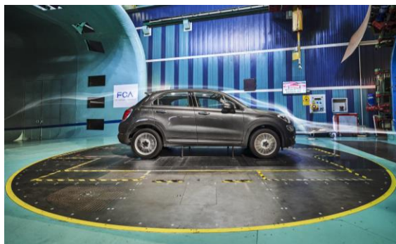
Obr. 1 Aerodynamický tunel pre fyzické skúmanie aerodynamiky automobilu [6]
