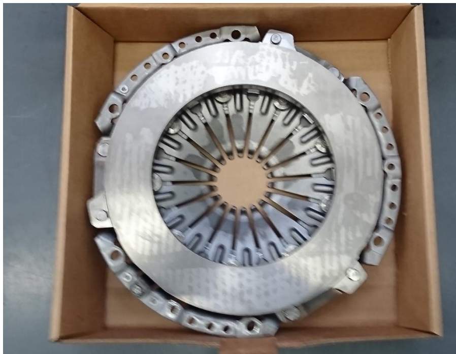
Obrázok 8 Spojka zložená z veka a lamely
