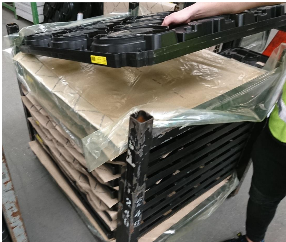
Obrázok 14 Ilustrácia použitia VCI papiera medzi preložkami
