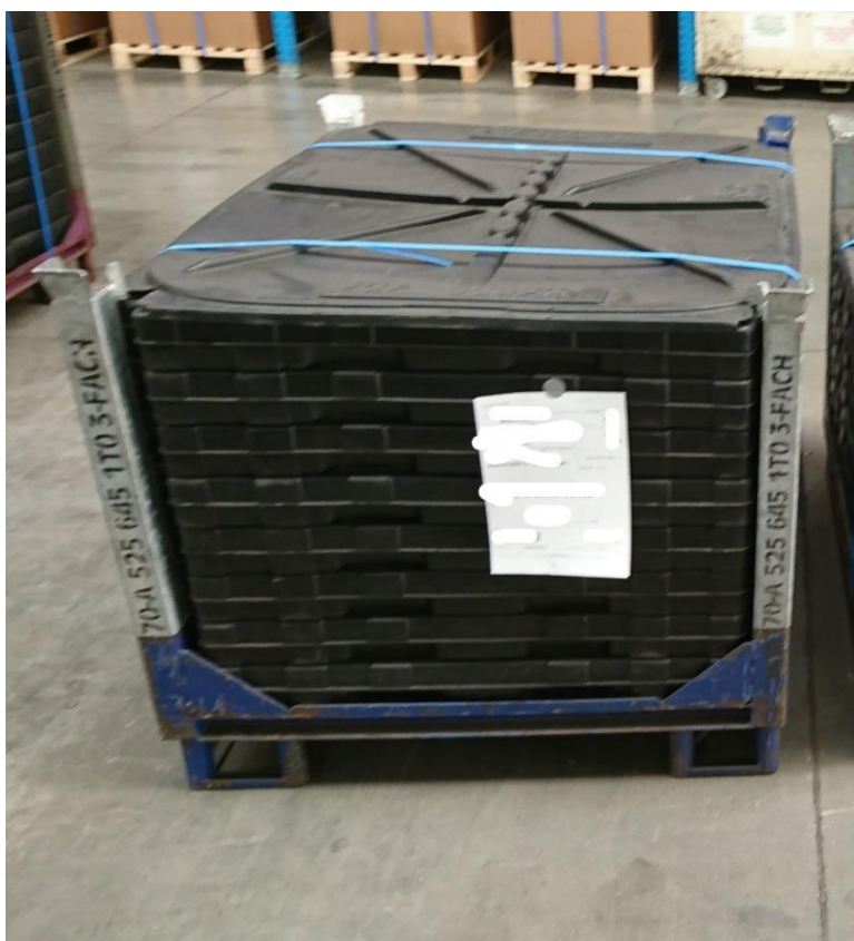
Obrázok 10 Obaly spojok zložené z palety, preložiek a dekla
