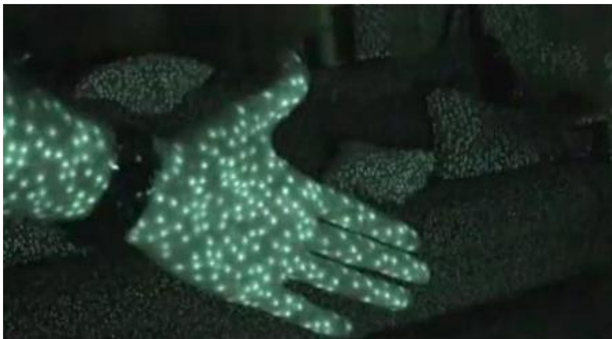
Obrázok 5 - Testovanie technológie infračervených bodov
