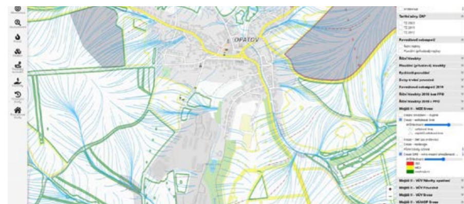
▲ Mapa 2: Opatov s kombinací vrstev: klasifikace erozní ochrany DPB, odtokové linie, DPB, kde došlo k erozní události
