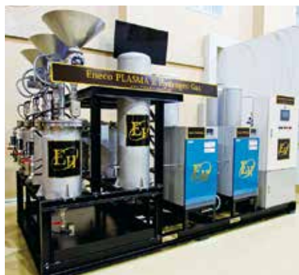
Obrázek č. 7: Japonský vyvíječ kyslíkovodíkového plynu Eneco Plasma Hydrogen Gas o výkonu 2,4 tun HHO plynu za den
