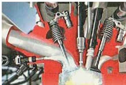
Obrázek č. 6: Tovární úprava vstřikování vody do válce motoru automobilu BMW M4 GTX
