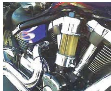
Obrázek č. 5: Vyvíječ kyslíkovodíkového plynu amatérsky instalovaný na motocyklu Harley
