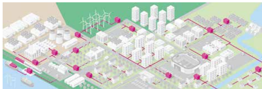
Obrázek č. 1: Bateriová úložiště jsou v současnosti nedílnou součástí chytré sítě. Uplatní se ve fázi výroby, distribuce i spotřeby elektřiny.
