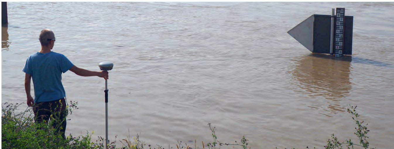
Zameriavanie výšky hladiny pomocou GPS počas povodňovej situácie, foto M. Lukáč
