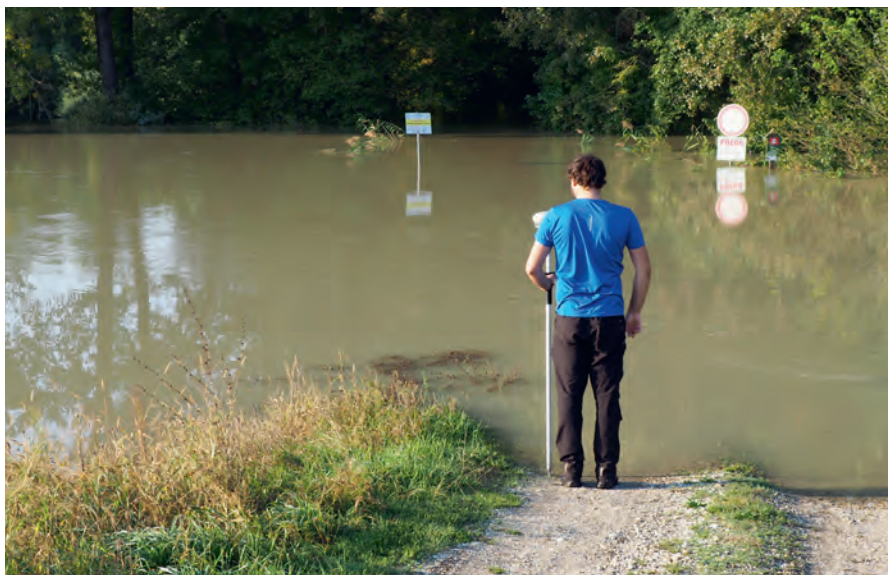
Zameriavanie výšky hladiny pomocou GPS, foto M. Lukáč
