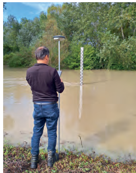
Zameriavanie výšky hladiny v teréne počas povodní, foto M. Lukáč
