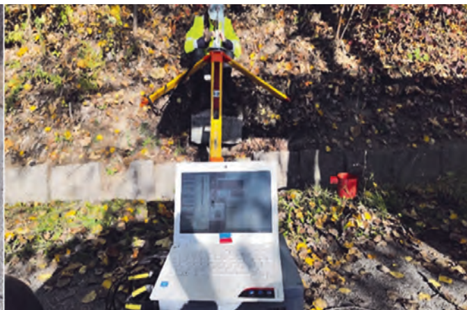
Obr. č. 13 Automatizované snímače vodivosti (vľavo), vrtulkový/tepelný pulzný prietokomer (vpravo)
