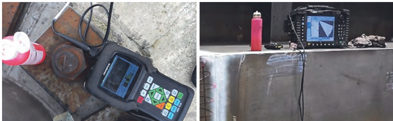
Obr. č. 15 Vybavenie pre meranie hrúbky materiálov (vľavo) a pre meranie metódou Phased array (vpravo)
