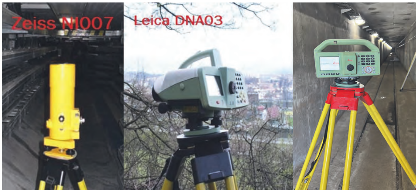
Obr. č. 5 Prístrojové vybavenie oddelenia geodézie na meranie zvislých posunov
