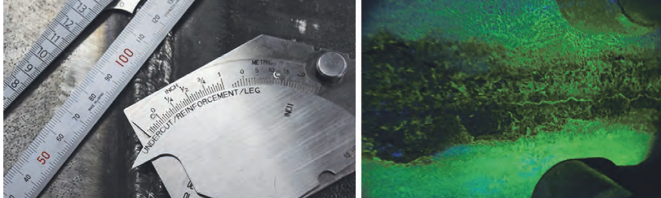
Obr. č. 14 Vizuálna kontrola (vľavo) a fluorescenčná magnetická kontrola (vpravo) zvarových spojov
