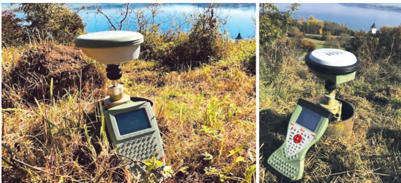
Obr. č. 8, 9 GNSS aparatury pri monitoringu vodorovných posunov zosuvného územia
