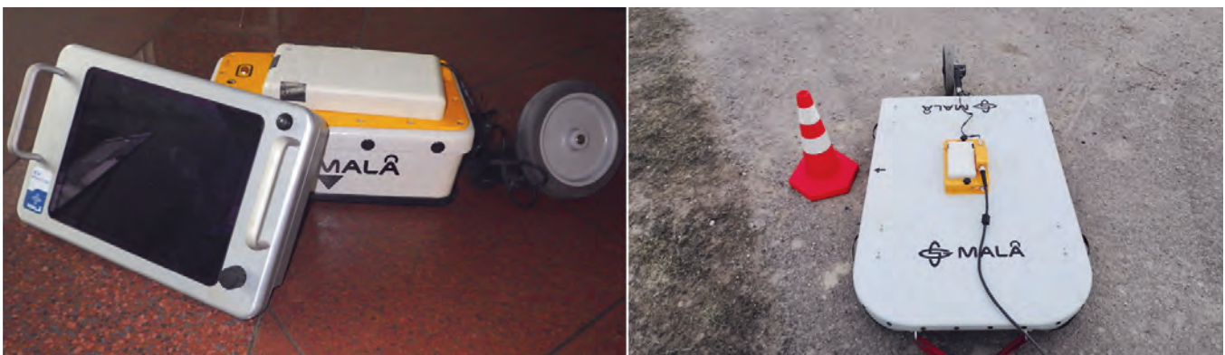
Obr. č. 12 Georadar – 800 MHz anténa (vľavo), 100 MHz – anténa (vpravo)
