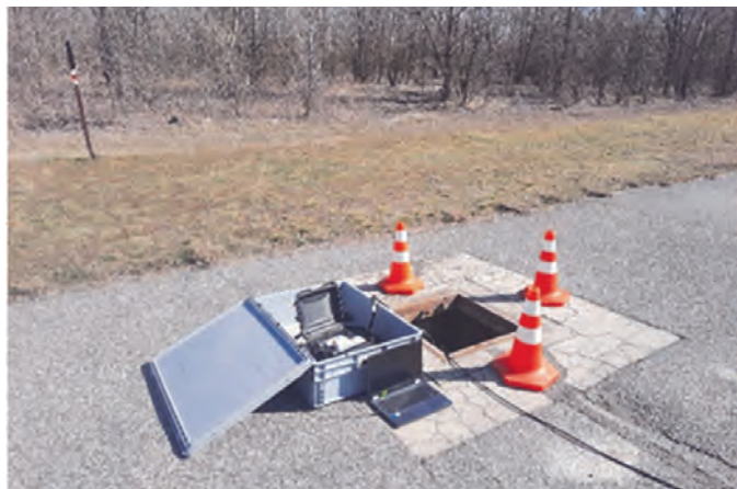
Obr. č. 13 Automatizované snímače vodivosti (vľavo), vrtulkový/tepelný pulzný prietokomer (vpravo)
