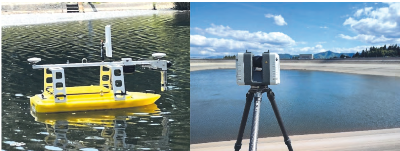
Obr. č. 6, 7 Skener RTC a loď so zabudovaným multibeam sonarom
