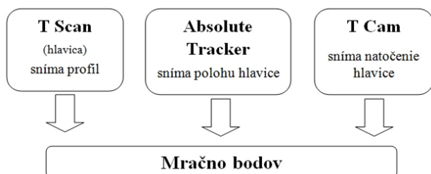
Obr. 3 Princíp činnosti skeneru Leica
