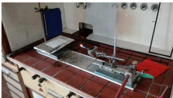
Obrázok 4 Skúšobné zariadenie podľa normy STN EN ISO 6940 [5]
