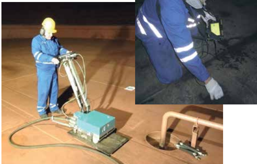
Obrázek č. 4: Ultrazukové měření tloušťky a podlahový skener SLOFEC
