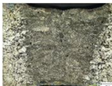
Obr. 3 Štruktúry zvarového spoja TWB 2 a) základný materiál DX53D+Z; b) TOO ocele DX54D+Z; c) zvarový kov TWB 2
