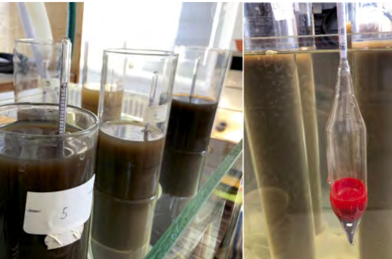
Obr. 12 Hustoměrná metoda zrnitostního rozboru (A. Casagrande)
