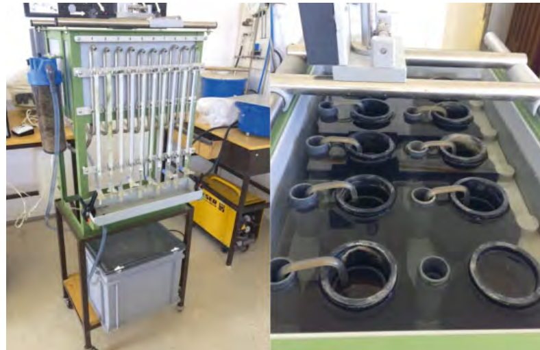
Obr. 13 Permeametr s konstantním spádem
