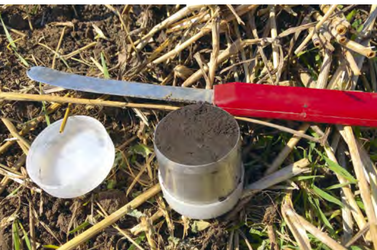
Obr. 7 Odběr půdního vzorku do Kopeckého válečku
