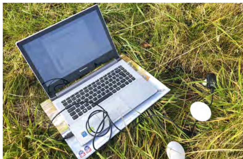
Obr. 9 Stahování dat z vlhkostních čidel v terénu
