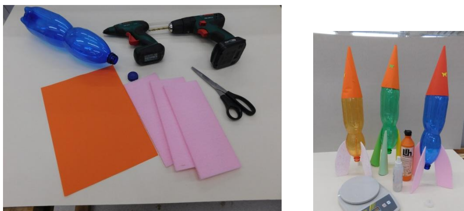
Obrázek 1 – Materiál a pomůcky a hotové rakety na ethanol z PET lahvi (foto autor).
