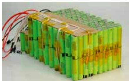
Obrázek č. 3: Neschopnost vyrobit článek NMC o vyšší kapacitě se nahrazuje jejich vzájemným propojováním do obrovských celků. Dokážete si představit, že vyměníte jeden vadný článek ze středu svařence?
