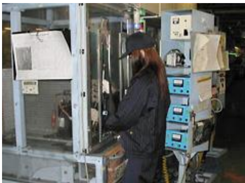
Obrázok 6: Kontrola úniku plynu zo spájkovaných častí použitím detektora Zdroj: Vlastné spracovanie podľa interných zdrojov skúmaného podniku
