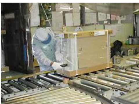
Obrázok 7: Finálna kontrola úniku plynu kompletného produktu pomocou detektora Zdroj: Vlastné spracovanie podľa interných zdrojov skúmaného podniku
