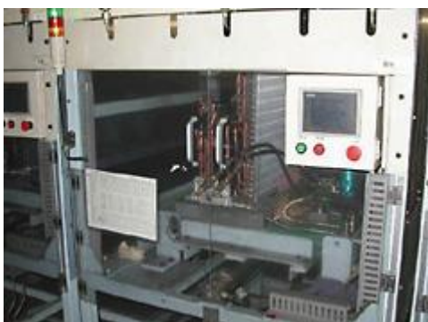
Obrázok 5: Kontrola vzduchotesnosti a tlakovej odolnosti Zdroj: Vlastné spracovanie podľa interných zdrojov skúmaného podniku
