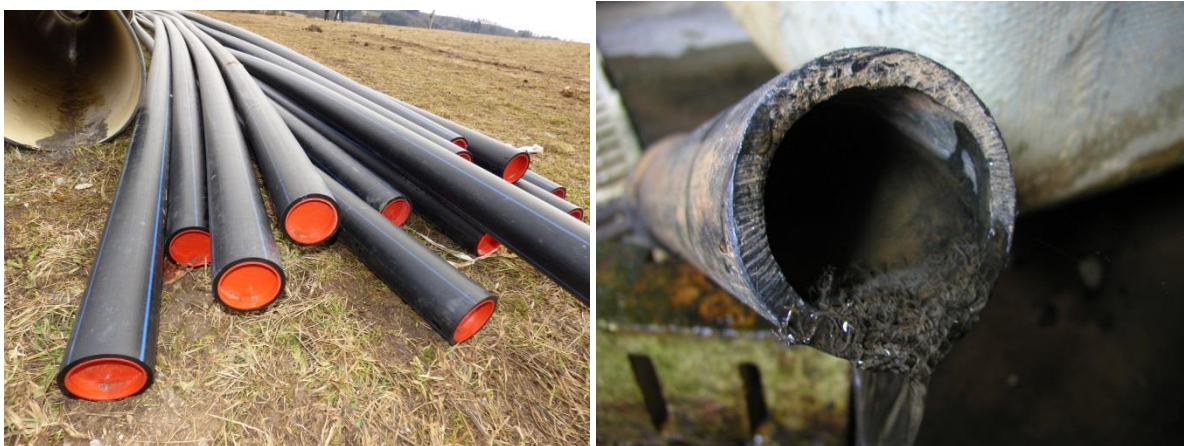
Obr. 5: Potrubí je uzavřeno před jeho zapojení zátkami, které brání kontaminaci mikroorganismy z prostředí (vlevo); ve starém potrubí slepého vodovodního řádu může být vytvořena silná vrstva biofilmu (vpravo).
