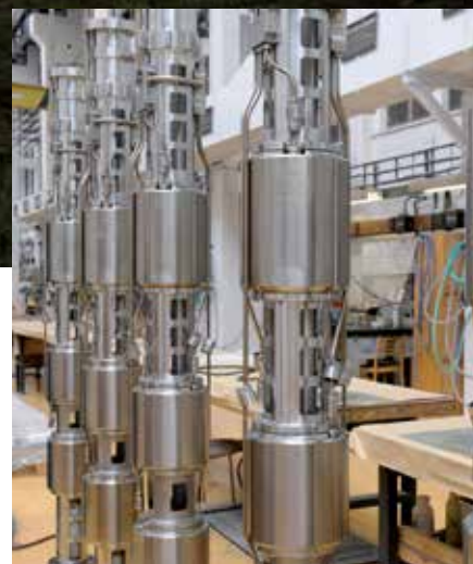
Obrázek č. 4: Montáž bloku elektromagnetů pro lineární krokové pohony řídicích tyčí reaktoru VVER-1000
